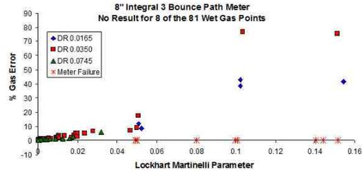
Fig 22. 8", 3 Bounce Path USM Wet Gas Data.
