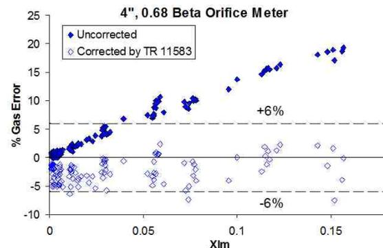
Fig 15. 4", 0.68 $\beta$  Orifice Meter Wet Gas Data.
